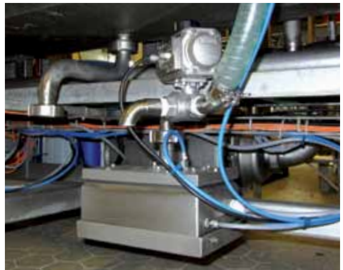
Das Verneblermodul ist unter der Verpackungsmaschine angebracht
